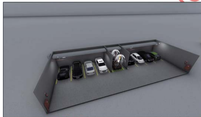
Nicho separado por barreiras verticais, com dois pontos de "chuveiros automáticos" e TRRF-90
