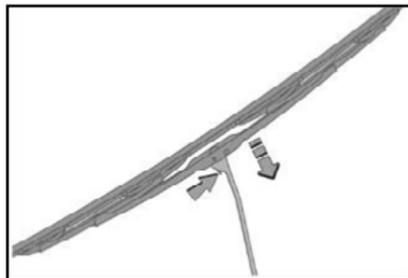
3. Pressione o botão de travamento, pressione a palheta na direção da seta até que ela se separe totalmente do gancho e retire-a girando.
