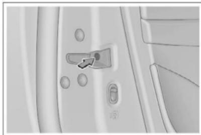
■ Para destravar as portas, acione a chave mecânica para destravar a porta dianteira esquerda e, em seguida, acione as maçanetas internas das outras portas para destravar antes de puxar uma maçaneta externa para abrir a porta correspondente.
