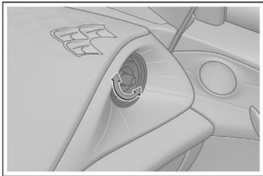
Use a folha de ajuste para ajustar o nível de velocidade do ventilador ou o ângulo de saída do ar. Faça com que a folha de ajuste chegue ao limite para fechar a saída de ar.
