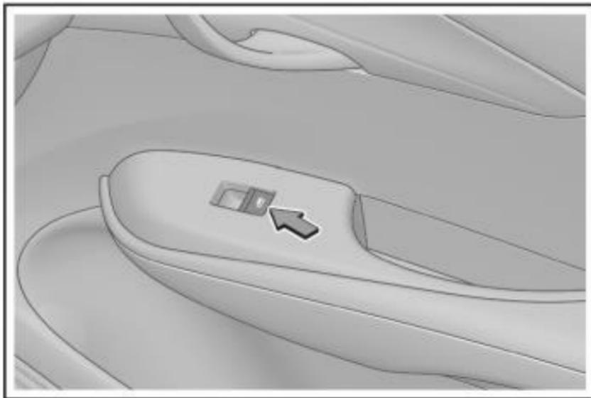
Quando o sistema do veículo estiver energizado (OK), os interruptores reguladores do vidro dianteiro direito e do vidro da porta traseira direita podem ser usados para regular os vidros das portas dianteira e traseira direita, respectivamente.
