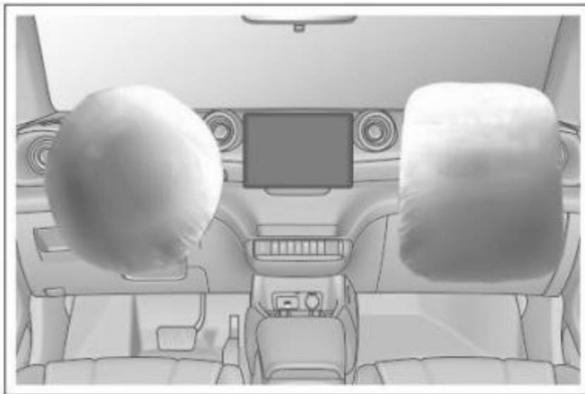
Caso a unidade de controle eletrônico (ECU) do sistema de retenção complementar identifique uma condição de colisão frontal de gravidade média a severa durante a condução do veículo e as condições de acionamento do SRS sejam satisfeitas, os airbags, caso equipado, serão acionados para reduzir o risco ou a gravidade de ferimentos.
