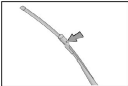
3. Segure o clipe da palheta do limpador para retirá-la na direção mostrada na figura.
