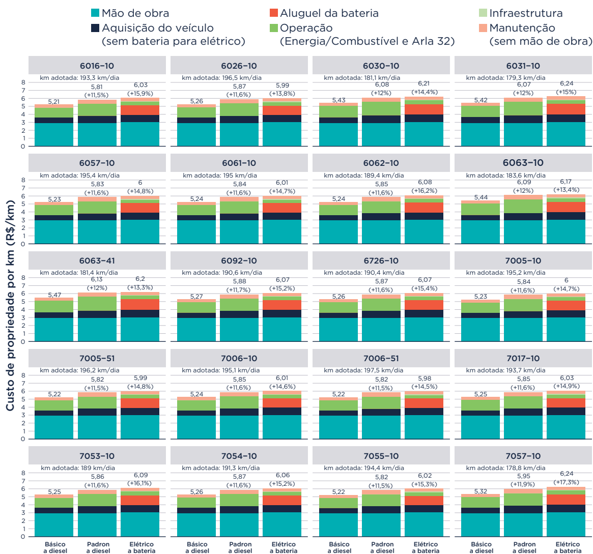
Figura 6. Estimativas do TCO por quilômetro para 20 linhas da Transwolff, considerando um período de 15 anos, por componente de custo, linha e tecnologia, em R$/km. A quilometragem diária dos ônibus corresponde à autonomia do ônibus elétrico em um cenário conservador com 100% de carregamento de passageiros, uma reserva técnica de 20% e uma degradação de 10% da bateria. Os percentuais em parênteses indicam a diferença do TCO de cada tecnologia em relação ao ônibus básico a diesel.
