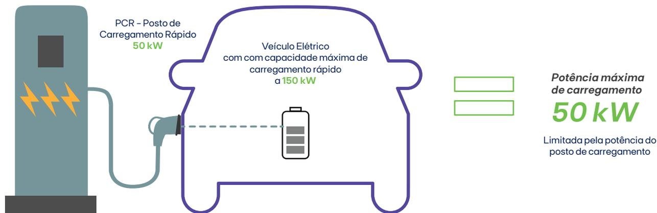
Um **veículo elétrico, com a capacidade máxima de carregamento rápido até 50 kW**, ao carregar num **Posto de Carregamento Rápido de 150 kW**, só carrega à potência máxima que o veículo permite, ou seja, **a 50 kW**.
