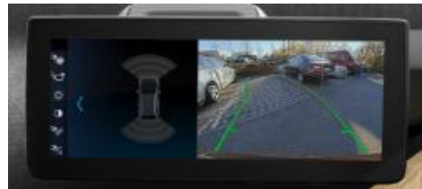
Parking Assistant com câmera de ré e sensor de estacionamento dianteiro e traseiro
