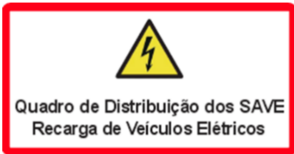
Figura 3: Sinalização de quadros de distribuição dos SAVE
