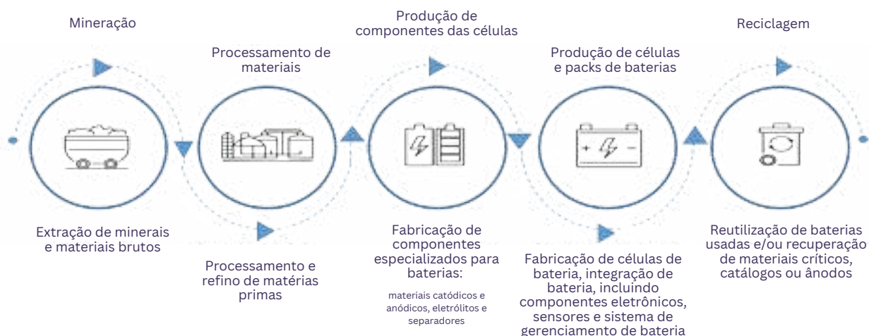
Figura 3 – Visão geral da cadeia de valor de baterias
